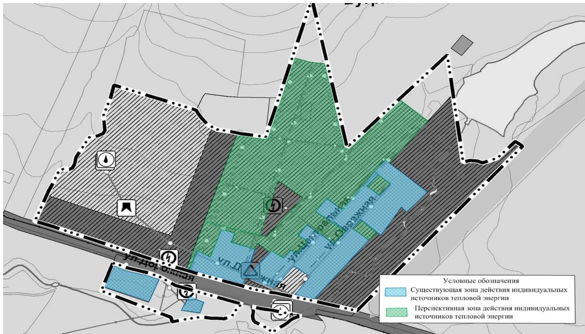
Рис. № 26 - Существующие и перспективные зоны действия индивидуального теплоснабжения на территории п. Бугринка
