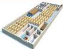
**Убежище** — защитное сооружение гражданской обороны, предназначенное для защиты укрытых в течение нормативного времени от расчетного воздействия поражающих факторов:
